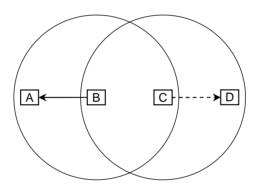
Ascoltando il mezzo, C sentirà la trasmissione di B e concluderà erroneamente di non poter trasmettere; invece, essendo D fuori della portata di B, ed A fuori della portata di C, le due trasmissioni potrebbero avvenire parallelamente senza interferenze.
